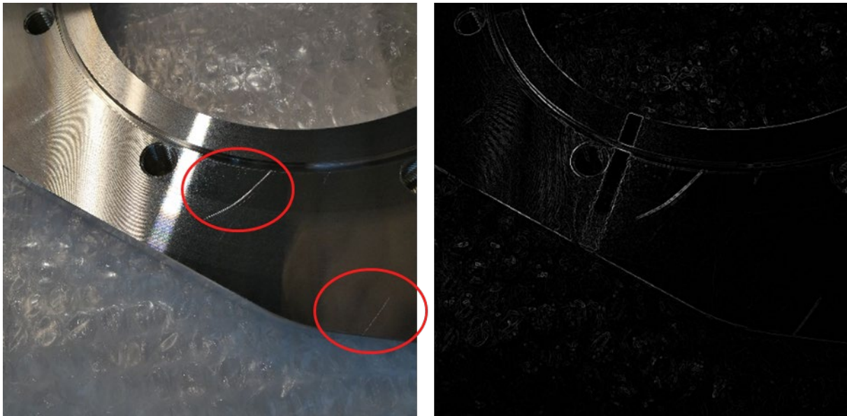
Abbildung 2: Bildverarbeitung mittels Canny-Algorithmus
